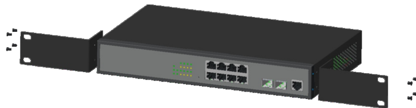
图2-1 安装挂耳示意图
