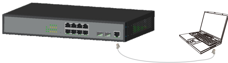
图2-5 连接配置线缆
