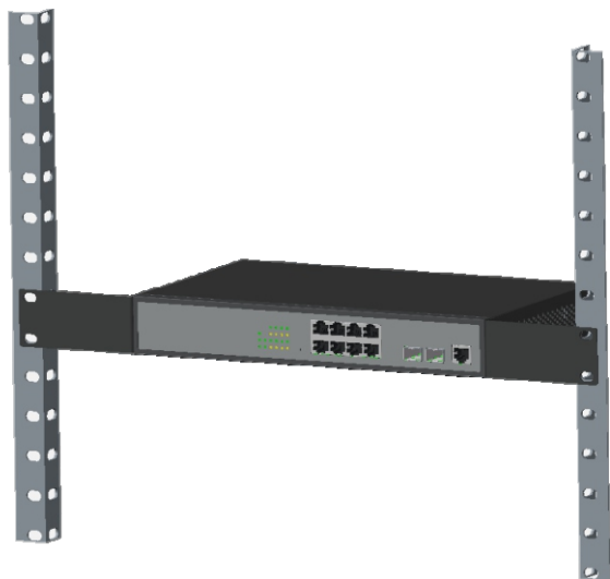
图2-2 将交换机安装到机柜上
