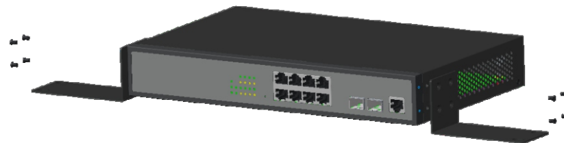
图2-3 安装挂耳示意图
